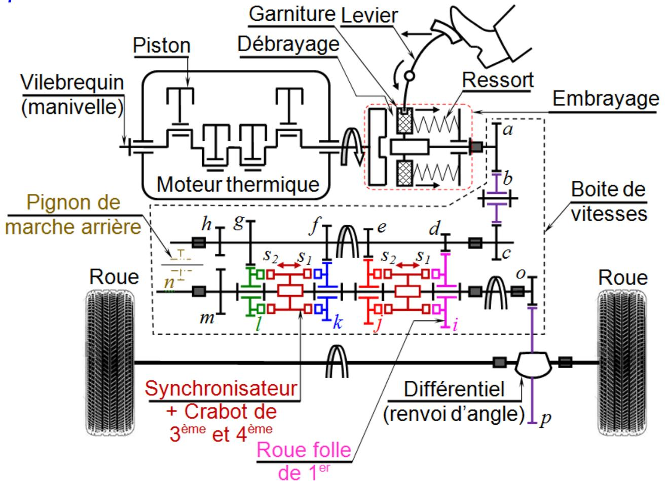
**Compléter** le sens de rotation des 3 arbres en cas d'embrayage et la sélection du 1<sup>er</sup> vitesse.
