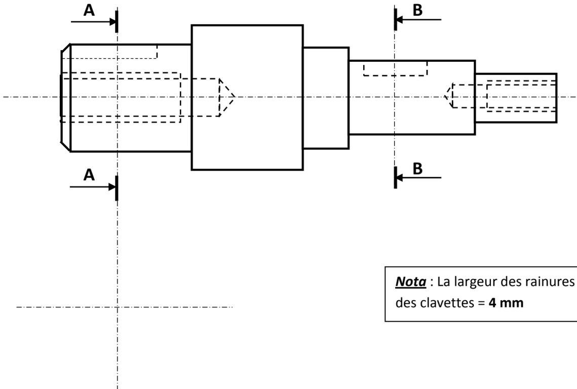
**Nota** : La largeur des rainures des clavettes = 4 mm
