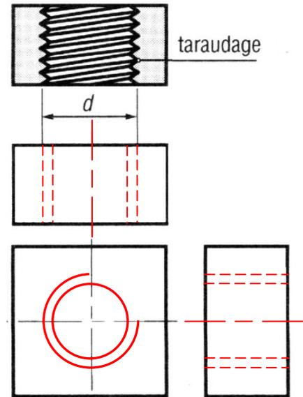
7.2- Compléter le dessin de l'assemblage entre la pièce 1 et 2 par la vis 3 ?
