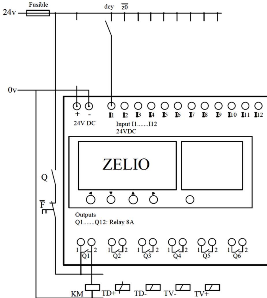
TD- , TD+, TV- et TV+ : sont des électro-aimants des distributeurs de commande des vérins de la trappe de vidange et de la trappe de la trémie d'alimentation.
