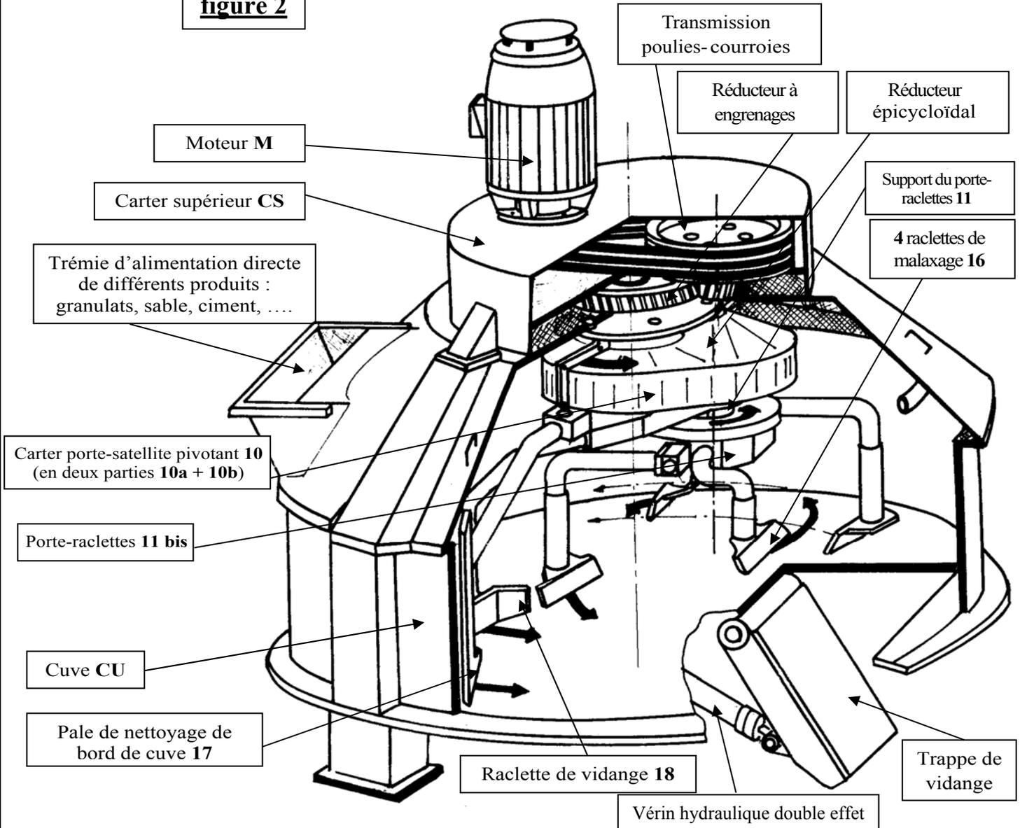
Le Moteur **M** entraîne en rotation la poulie motrice **1**. Celle-ci entraîne à son tour la poulie réceptrice **2** par l'intermédiaire de la courroie trapézoïdale **3**. Le pignon arbré d'entrée **4** engrène avec la roue dentée primaire **5**, on a ainsi une transmission primaire à deux étages de réduction.
