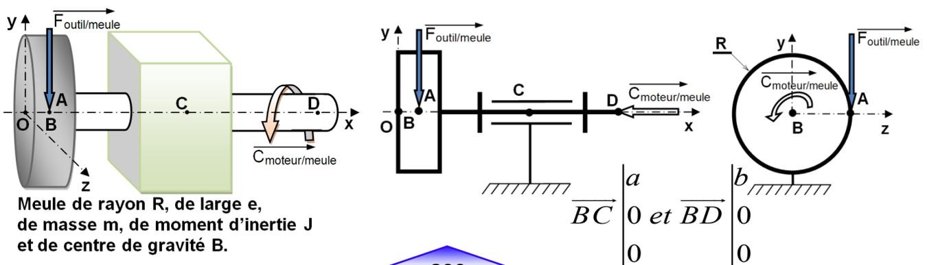
Meule de rayon R, de large e, de masse m, de moment d'inertie J et de centre de gravité B.
