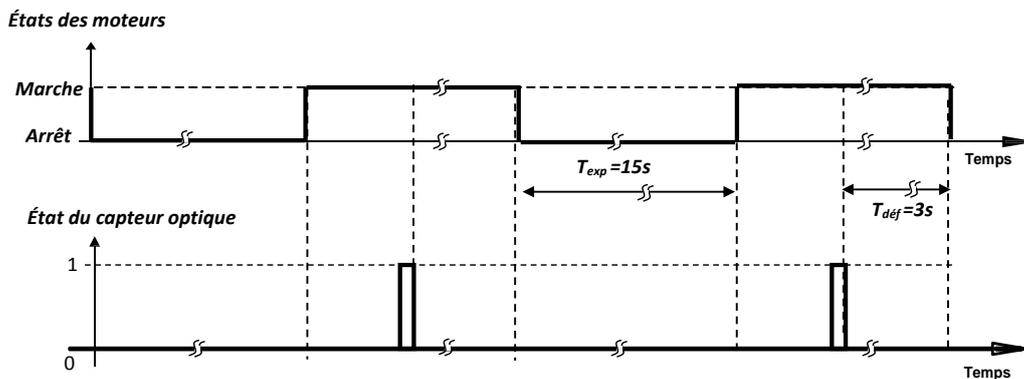
Figure 4 : Défilement et détection du passage des affiches
