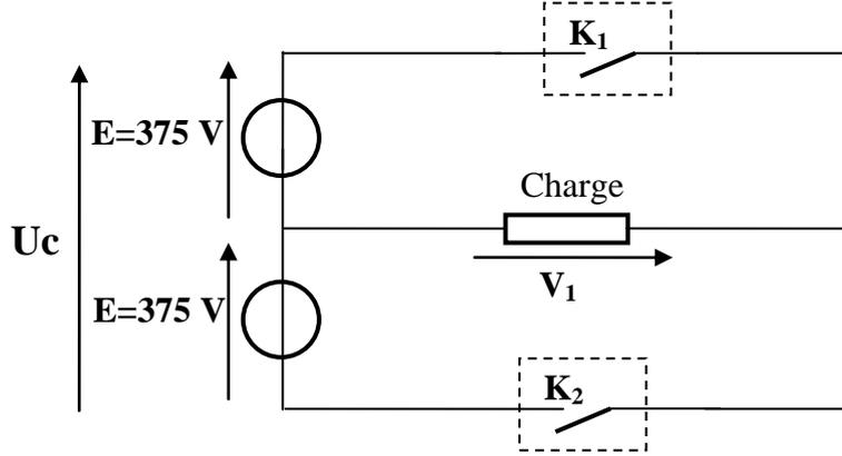
**Figure 25 : schéma de principe de l'onduleur**
