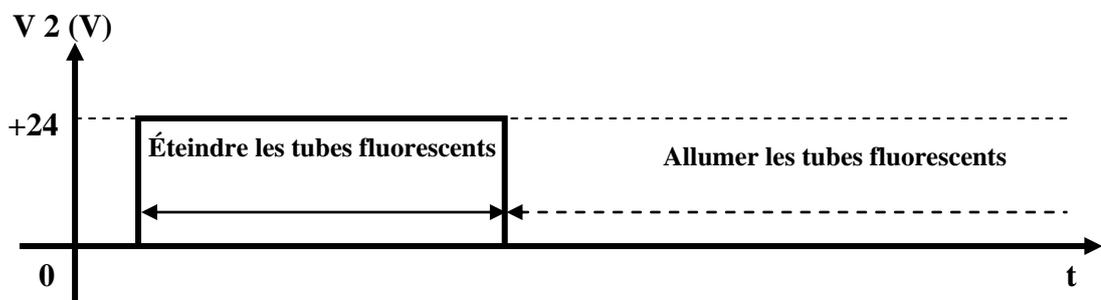
**Figure 19 : Signal de commande de l'éclairage**
