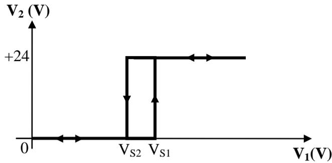
**Figure 17 : Fonction de transfert (Trigger + Adaptateur du signal)**
