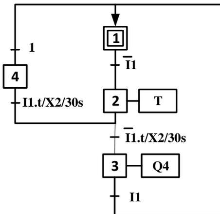
Figure 20 : Grafcet de point de vue commande
