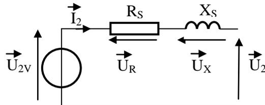
**Figure 24 : Schéma équivalent du transformateur vu du secondaire**
