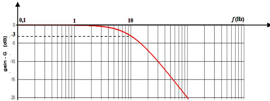
**Figure 15 : Réponse en fréquence du filtre**
