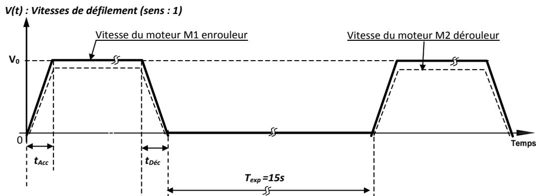
Figure 7 : Vitesses d'enroulement et de déroulement des affiches
