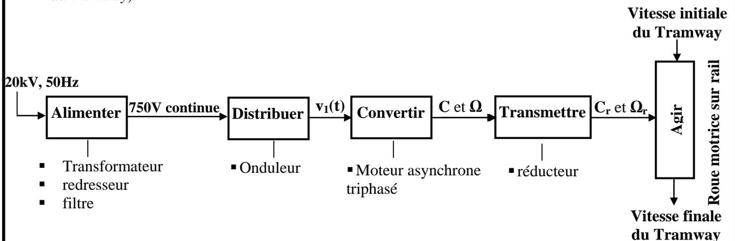
Figure 22 : Chaîne énergétique simplifiée du Tramway
