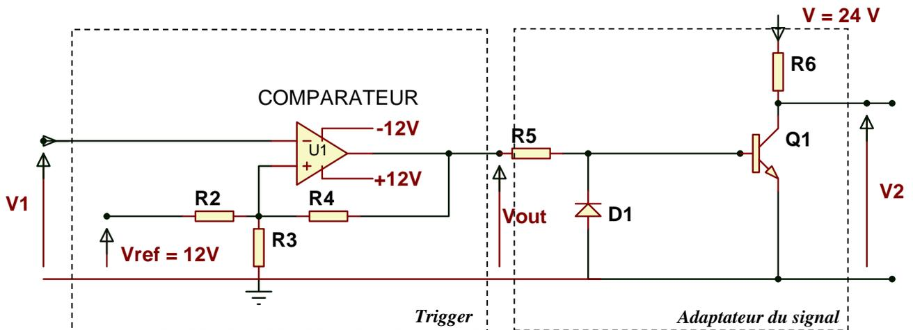
**Figure 16 : Trigger et adaptateur du signal**
