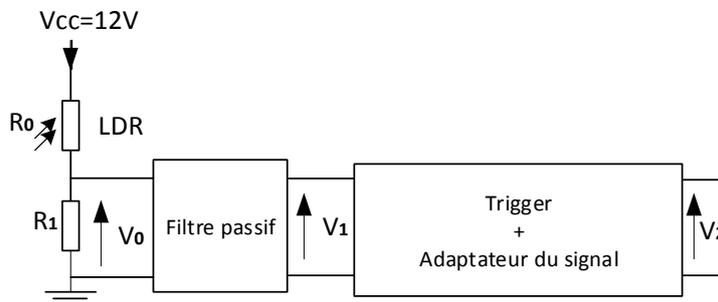
**Figure 11 : Acquisition, conditionnement du signal de l'éclairage**
