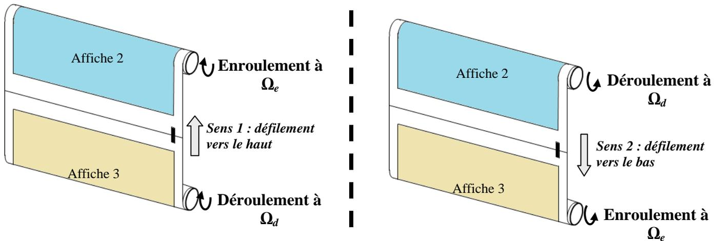
Figure 6 : Enroulement, déroulement et tension des affiches
