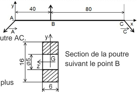
Section de la poutre suivant le point B
