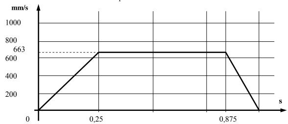
1- A partir du graphe des vitesses du lot  $V_L$ =f(t), remplir le tableau en indiquant, pour chacune des trois phases, les conditions initiales et finales, et en calculant l'accélération et la vitesse du lot.
