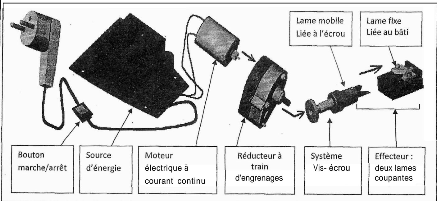
**6- Ensemble éclaté du système électromécanique :**
